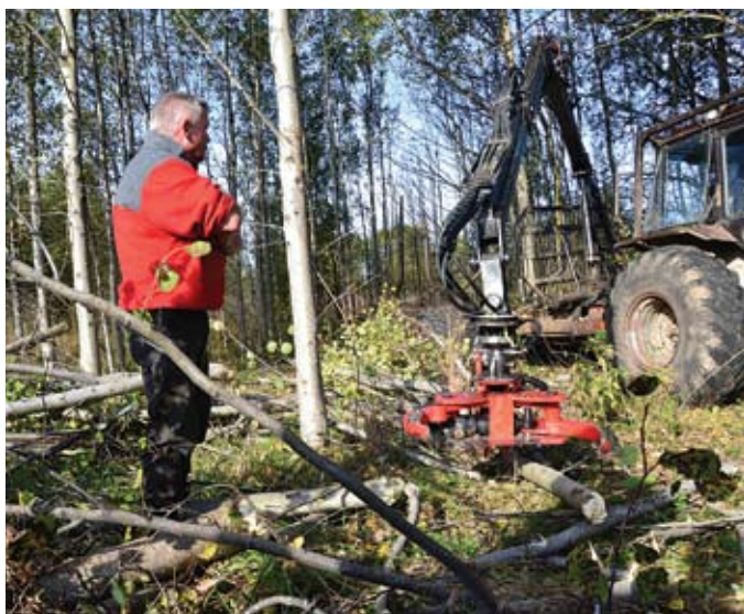
Mehānizēta jaunaudzes kopšana izmantojot ar „kniebēģgalvu” aprīkotu lauksaimniecības traktora hidromanipulatoru
