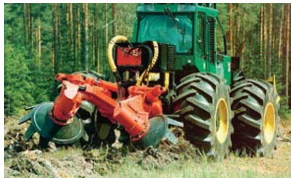
Uzņēmums „Metsaliitto Latvija SIA” augsnes sagatavošanai pielieto frezi un kupicotāju TTS Delta Combi, tā darba ražīgums ir ap 0,77 ha/stundā. Sīkāka informācija: www.metsaliitto.lv
